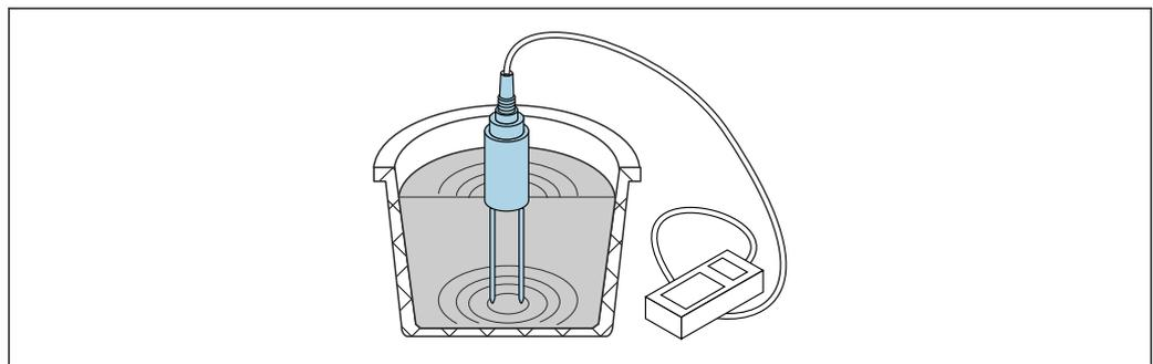
图 20 有效测量体积 (图示波形)
