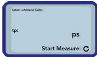
进行四次测量以提高准确性。然后计算这些测量值的平均值。测量时间约为 20 秒。测量完成后，将短暂显示测量脉冲渡越时间。
