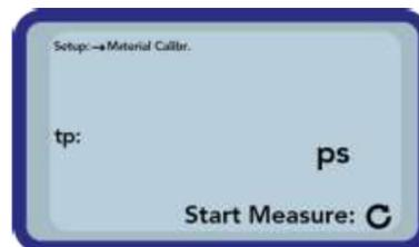
进行四次测量以提高准确性。然后计算这些测量值的平均值。测量时间约为 20 秒。测量完成后，将短暂显示测量脉冲过渡时间。
